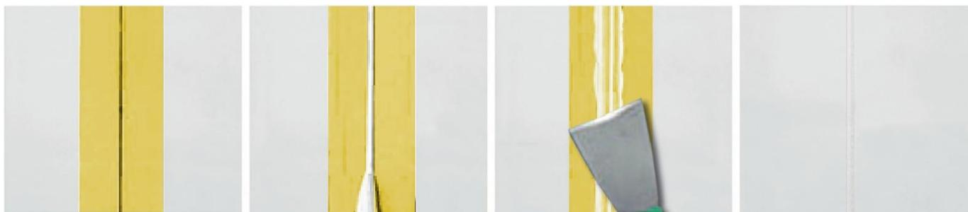
*Protéger la surface des panneaux en utilisant un ruban adhésif afin d'éviter les taches de colle sur la surface.*
